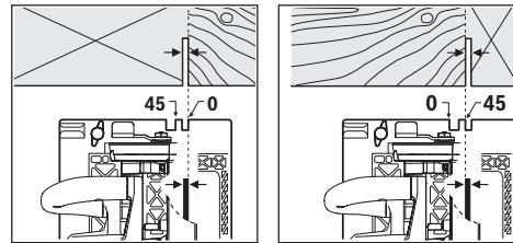
Tanda pemotongan 0° (8) menunjukkan posisi mata gergaji pada pemotongan persegi. Tanda pemotongan 45° (9) menunjukkan posisi mata gergaji pada pemotongan 45°. Untuk melakukan pemotongan yang tepat, dekatkan mesin gergaji bundar pada benda kerja seperti yang terlihat pada gambar. Sebaiknya lakukan uji coba pemotongan terlebih dulu.
