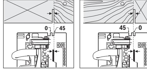
Tanda pemotongan 0° (9) menunjukkan posisi mata gergaji pada pemotongan persegi. Tanda pemotongan 45° (8) menunjukkan posisi mata gergaji pada pemotongan 45°. Untuk melakukan pemotongan yang tepat, dekatkan mesin gergaji bundar pada benda kerja seperti yang terlihat pada gambar.
