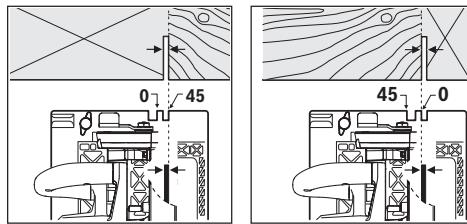
La marca de posición para  $0^\circ$  (9) muestra la posición de la hoja de sierra en caso de corte en ángulo recto. La marca de corte  $45^\circ$  (8) muestra la posición del disco de sierra en caso de corte de  $45^\circ$ .
