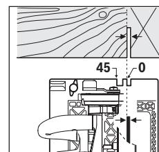
Le marquage de coupe 0° (9) indique la position de la lame de scie lors d'une coupe à angle droit. Le marquage de coupe 45° (8) indique la position de la lame de scie lors d'une coupe à 45°.
