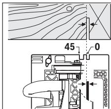
A marcação de corte de  $0^\circ$  (9) indica a posição da lâmina de serra num corte em ângulo reto. A marcação de corte de  $45^\circ$
