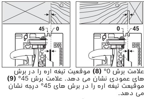
برای انجام یک برش دقیق طبق اندازه، اره را طبق تصور بر روی قطعه کار قرار دهید. بهتر است یک برش آزمایشی انجام دهید.
