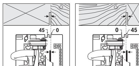
La marca de posición para 0° (8) muestra la posición de la hoja de sierra en caso de corte en ángulo recto. La marca de corte 45° (9) muestra la posición del disco de sierra en caso de corte de 45°.
