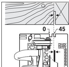
A marcação de corte de  $0^\circ$  (8) indica a posição da lâmina de serra num corte em ângulo reto. A marcação de corte de  $45^\circ$  (9) indica a posição do disco de serra num corte num ângulo de  $45^\circ$ .
