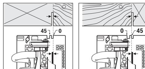
เครื่องหมายตัด **0° (8)** แสดงตำแหน่งของใบเลื่อยสำหรับการตัดเป็นมุมฉาก เครื่องหมายตัด **45° (9)** แสดงตำแหน่งของใบเลื่อยสำหรับการตัด **45°** เพื่อให้ได้การตัดที่แม่นยำ ให้จับเลื่อยวงเดือนเข้าหากาชีงงานดังแสดงในภาพ ทางที่ต้องสุดควรฝึกซ้อมการตัดก่อน
