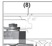
Utilice solamente la marca de corte (8) en el caso de un corte rectangular y un corte de  $45^\circ$  con riel de guía.
