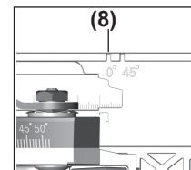
Chỉ sử dụng đánh dấu vết cắt (8) đối với vết cắt vuông góc và vết cắt 45° có ray dẫn hướng.
