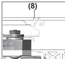
Utilize apenas marcação de corte **(8)** no corte em ângulo reto e no corte em 45° com calha de guia.
