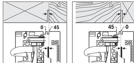
A marcação de corte 0° (9) indica a posição do disco de serra no corte em ângulo reto. A marcação de corte 45° (8) indica a posição do disco de serra no corte em 45°.
