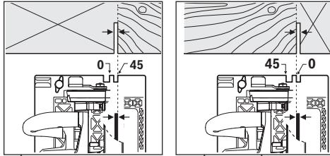
เครื่องหมายตัด **0° (9)** แสดงตำแหน่งของใบเลื่อยสำหรับการตัด เครื่องหมายตัด **45° (8)** แสดงตำแหน่งของใบเลื่อยสำหรับการตัด **45°** เพื่อให้ได้การตัดที่แม่นยำ ให้จับเลื่อยวงเดือนเข้าหากาชีงงานดังแสดงในภาพ ทางที่ต้องสุดควรฝึกซ้อมการตัดก่อน
