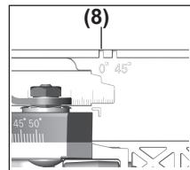
ใช้เฉพาะเครื่องหมายตัด **(8)** สำหรับการตัดเป็นมุมฉาก และสำหรับการตัด **45°**
