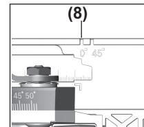
Use a marcação de corte (8) num corte em ângulo reto e num corte de  $45^\circ$  com calha de guia.
