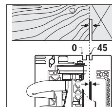
Le marquage de coupe 0° (8) indique la position de la lame de scie lors d'une coupe à angle droit. Le marquage de coupe 45° (9) indique la position de la lame de scie lors d'une coupe à 45°.
