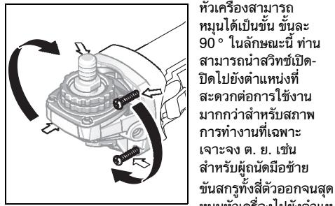
หมุนหัวเครื่องไป逆时针方向 โดยไม่กดดันจากตัวถัง ขันลกรูทั้งลักษ์เข้าไปและยืดให้แน่น
