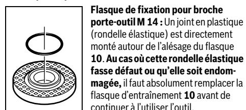
**Flasque de fixation pour broche porte-outil M 14 :** Un joint en plastique (rondelle élastique) est directement monté autour de l'alésage du flasque **10**. Au cas où cette rondelle élastique fasse défaut ou qu'elle soit endommagée, il faut absolument remplacer la flasque d'entraînement **10** avant de continuer à l'utiliser l'outil.
