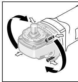
机器操作者可根据需要分段式转动机头，每一段的旋转角度为 90 度。此功能的优点是能够在特殊的工作状况下，把起停开关移动到比较容易操作的位置。例如切割时使用能够配合导引板的吸尘罩 20，或者针对左撇子。
