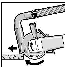
開動電動工具，並把導引裝置的前端放置在工件上。參考工件的物料，適當地施力推進機器。
