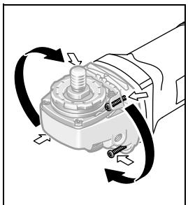
หัวเครื่องสามารถหมุนท่ามกลางกับตัวล้อเครื่องได้เป็นชั้น ขั้นละ 90° ในลักษณะนี้ลิวิท์ช์ปิด-ปิดสามารถเลื่อนไปอยู่ในตำแหน่งที่สะดวกของการใช้งานมากขึ้นเมื่อทำงานในสถานการณ์พิเศษ ด. ย. เช่น สำหรับการตัดที่ใช้แผ่นนำการตัดพร้อมฝารอบคูณ 20 หรือสำหรับผู้คนมือซ้าย
