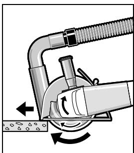
Mettez l'outil électroportatif en marche et positionnez-le avec la partie avant de la glissière de guidage sur la pièce à travailler. Travaillez en appliquant une vitesse d'avance modérée adaptée au matériau.
