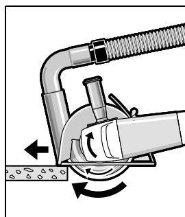
Bật công tắc lên và đưa phần trước của đường cắt lên trên vật gia công. Đẩy nhẹ máy tới cho ăn vào vừa phải, tùy theo loại vật liệu gia công mà thích nghi. Để cắt loại vật liệu đặt biệt rắn, vd., bê-tông có mật độ sỏi cao, đĩa cắt hạt kim cương có thể bị quá nóng và hotts quá là bị hư hỏng. Sự cố này được biểu hiện rõ bằng tia lửa bắn ra vòng tròn, quay cùng với đĩa cắt.
