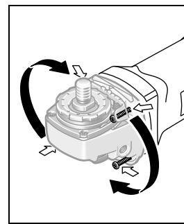
Đầu máy có thể xoay được đối với vỏ máy ở vào  $90^{\circ}$  nắc. Bằng cách này, công tắc Tắt/Mở có thể mang lại vị trí thuận lợi hơn đối với các tinh huống già công đặt biệt, vd., già công cắt có sử dụng đường cắt có chắn bảo vệ việc hút bụi **20** hay cho người thuận tay trái.
