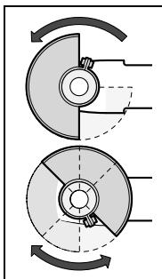
Pasangkan kap pelindung 7 pada poros kerja. Cocokkan kedudukan dari kap pelindung 7 dengan pekerjaan yang akan dilakukan. Kuncikan kap pelindung 7 dengan cara mengencangkan baut pengunci 8 dengan menggunakan kunci kombi 4.
