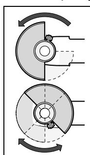
Lắp chắn bảo vệ 7 lên trên vòng cổ trực. Chỉnh đặt vị trí của chắn bảo vệ 7 phù hợp với yêu cầu của công đoạn gia công. Khóa chắn bảo vệ 7 bằng cách siết chặt vít khóa chắn 8 bằng chìa vặn kết hợp 4.
