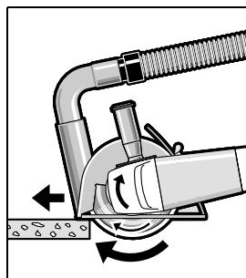
Ligar a ferramenta elétrica e colocá-la com a parte dianteira do carril de guia sobre a peça a ser trabalhada. Empurrar a ferramenta elétrica com avanço moderado, adequado ao material a ser trabalho.
