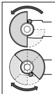
把防护罩 7 安装在主轴颈上。根据工作的需要调整好防护罩 7 的位置。固定好防护罩 7，此时要拧紧固定螺丝 8，拧紧时得借助通用扳手 4。
