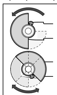
Montez le capot de protection 7 sur la broche d' entraînement. Adaptez la position du capot de protection 7 aux exigences des travaux à effectuer. Verrouillez le capot de protection 7 en serrant la vis de blocage 8 au moyen de la clé combinée 4.
