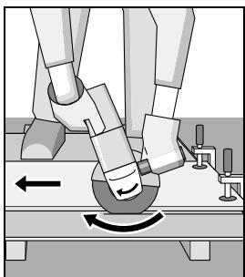
เครื่องต้องทำงานในทิศทางตรงกันข้ามกับการหมุนเสมอ มีฉะนั้นจะเกิดอันตรายจาก การที่เครื่องถูกดันออกจากวอร์ตัดโดยความคุณไม่ได้
