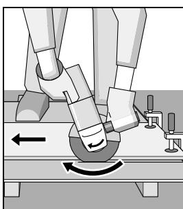
必须逆著机器的转向推动电动工具，否则容易失控，并导致电动工具从切线中滑出。
