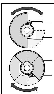
Colocar a cobertura de proteção 7 sobre a gola do veio. Adaptar a posição da cobertura de proteção 7 aos requisitos do processo de trabalho. Travar a cobertura de proteção 7 apertando o parafuso de fixação 8 com a chave combinada 4.
