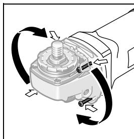
機器操作者可根據需要分段式轉動機頭，每一段的旋轉角度為 90 度。此功能的優點是能夠在特殊的工作狀況下，把起停開關移動到比較容易操作的位置。例如切割時使用能夠配合導引板的吸塵罩 20，或者針對左撇子。
