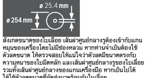
ลังเกดขนาดของใบเลื่อย เล่นผ่าศูนย์กลางรูต้องเข้ากับแกน หมุนของเครื่อง โดยไม่มีช่องหลุม หากทำตามจะเป็นต้องใช้ ตัวดูดขนาด ให้ตรวจสอบให้แน่ใจว่าตัวดูดมีขนาดตรงกับ ความหนาของใบเลื่อยแล้ว และเล่นผ่าศูนย์กลางรูของใบเลื่อย รวมทั้งลังเกดขนาดที่จัดส่งมาพร้อมกับใบเลื่อย ให้ใช้ตัวดูดขนาดที่จัดส่งมาพร้อมกับใบเลื่อย
